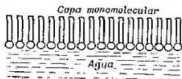
Fig. 215. Disposición de las moléculas de los ácidos grasos formando una capa monomolecular sobre la superficie del agua.
